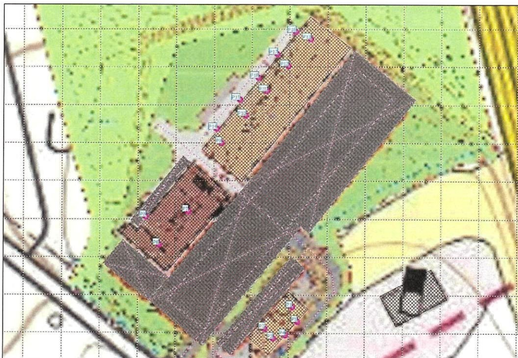
Obr. 1: Umístění stacionárních zdrojů hluku na střeše a fasádě objektů obchodního a stravovacího zařízení
